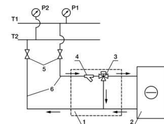
Возможная схема обвязки с 2-ходовым регулирующим клапаном
