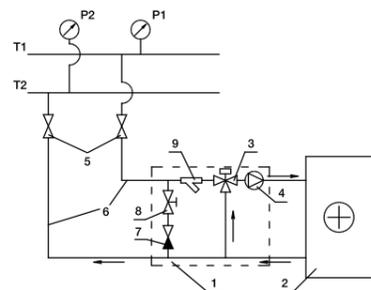
Возможная схема обвязки с 2-ходовым регулирующим клапаном
