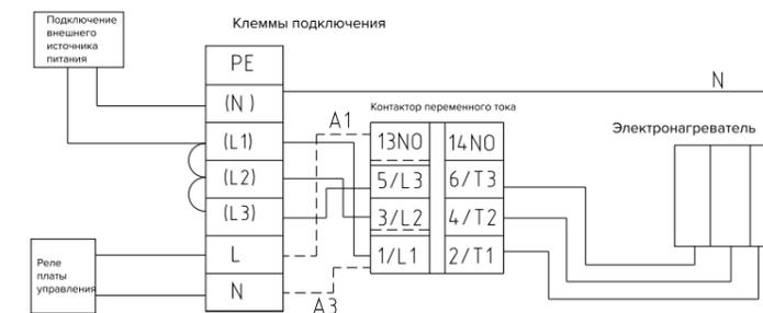
При подключении к сети 380 В три фазы подключаются к (L1), (L2), (L3) и нулевой линии (N). На печатной плате блока нулевая линия и линия фазы подключаются к N, L.
