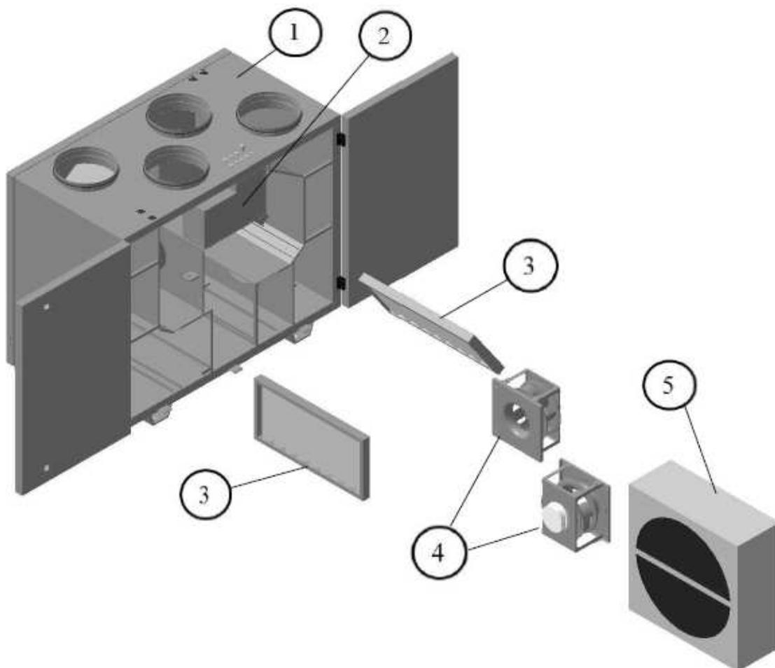
1 – Корпус, 2 – Панель автоматики, 3 – Фильтр, 4 – Вентилятор, 5 – Роторный рекуператор.
